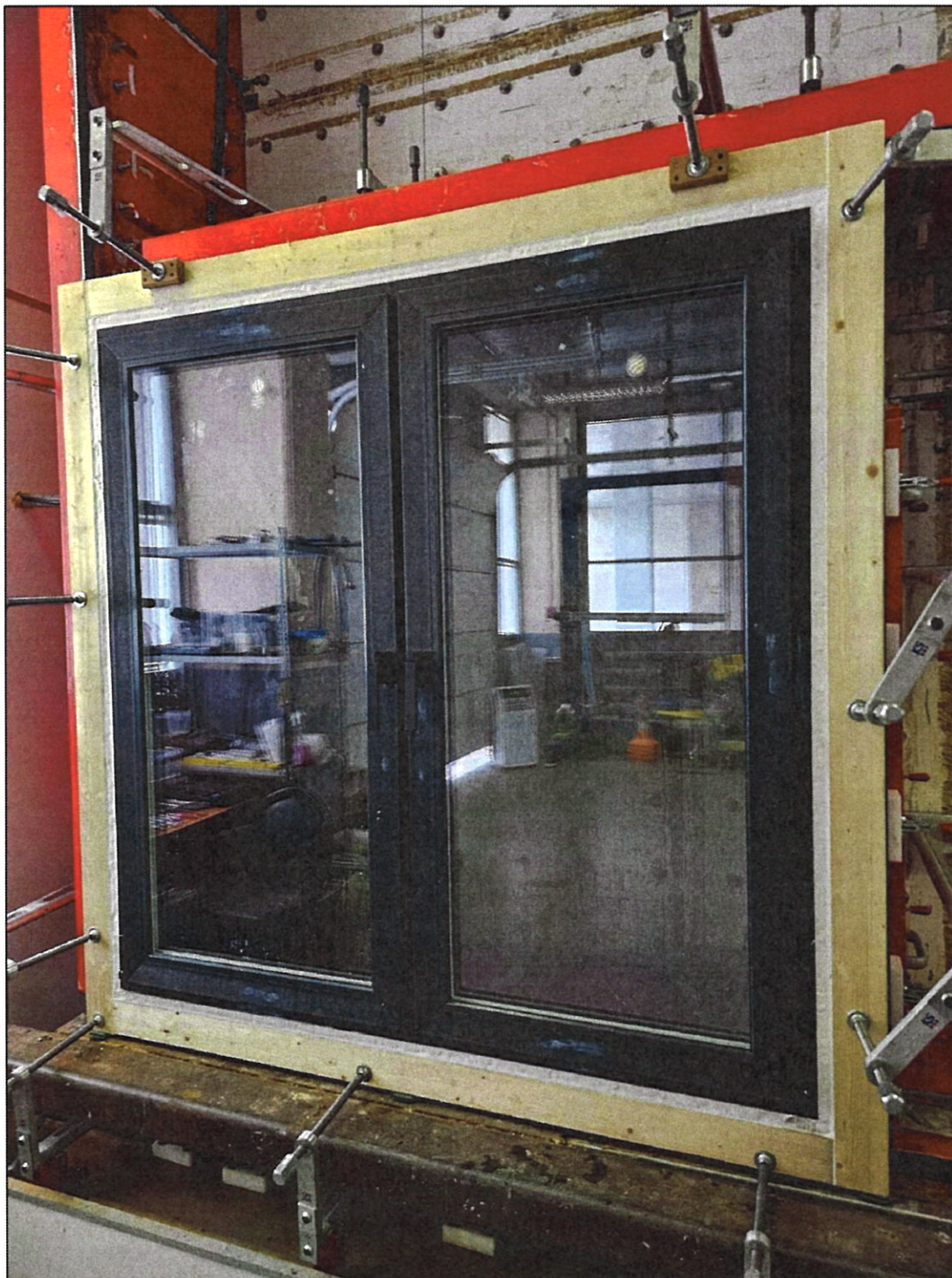
Рисунок 1– Образец 994-24-3, установленный на испытательный стенд (на этапе проведения испытаний на воздухопроницаемость)
