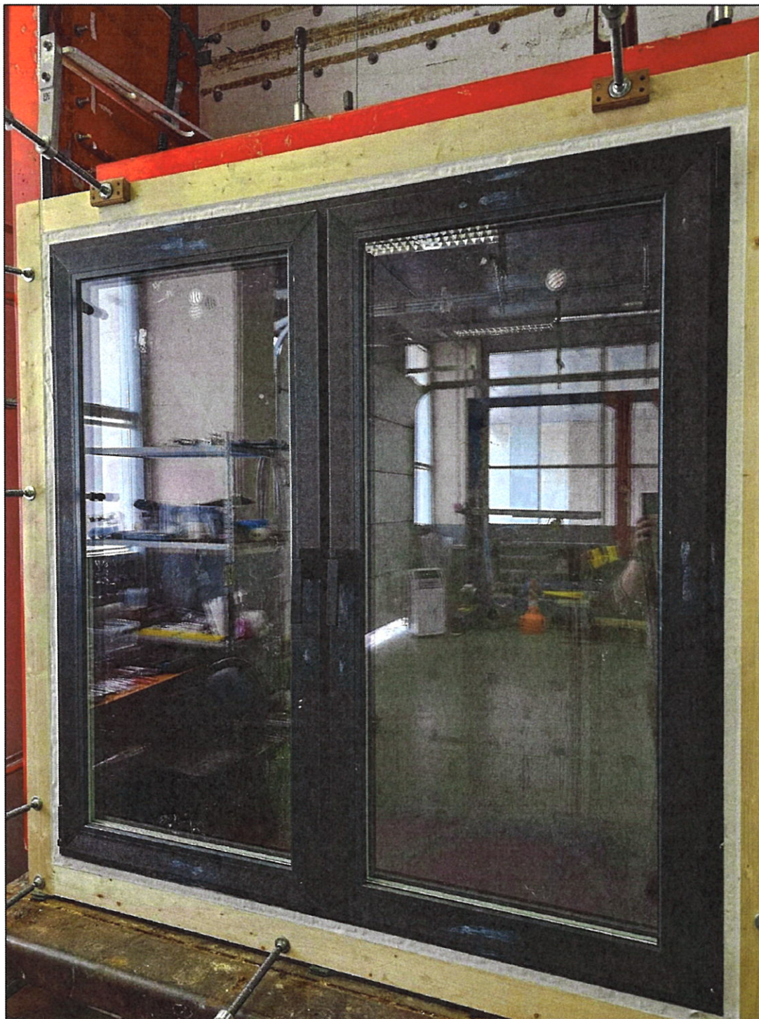
Рисунок 6– Внешний вид образца 994-24-3 в процессе испытаний на водонепроницаемость
