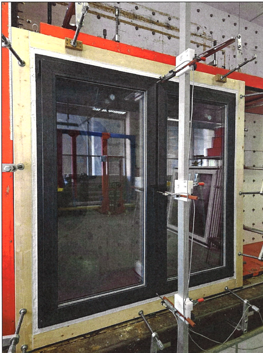
Рисунок 8– Внешний вид образца 994-24-3 в процессе испытаний на сопротивление ветровой нагрузке
