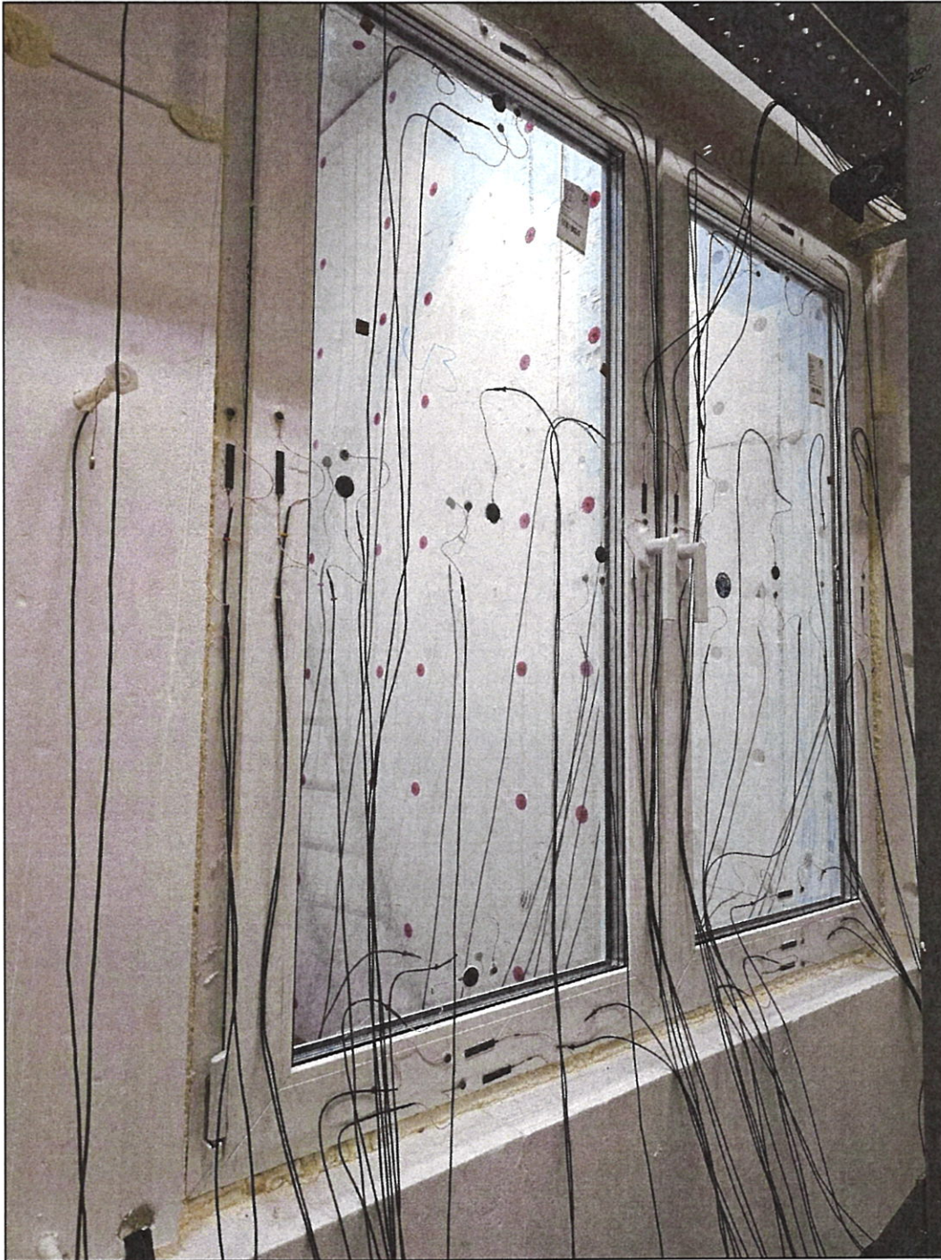
Рисунок 11– Внешний вид образца 994-24-2-2 в процессе испытаний по определению его приведенного сопротивления теплопередаче
