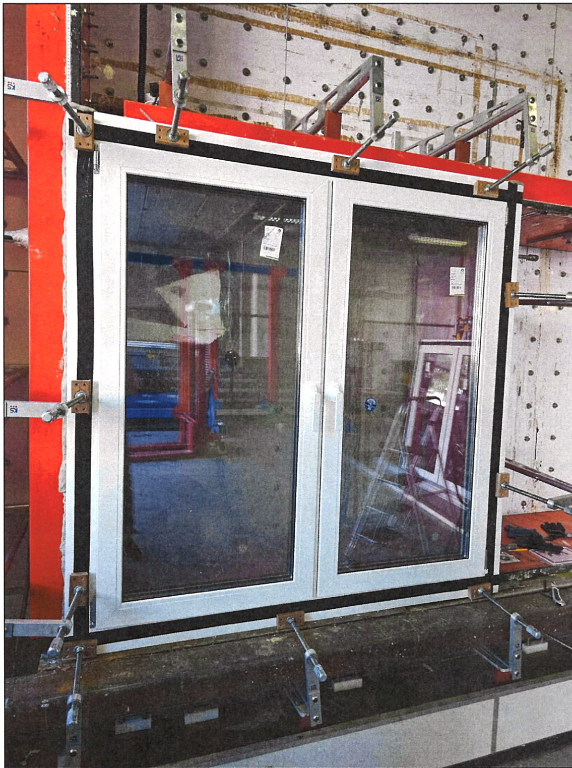
Рисунок 6– Внешний вид образца 994-24-2-2 в процессе испытаний на водонепроницаемость
