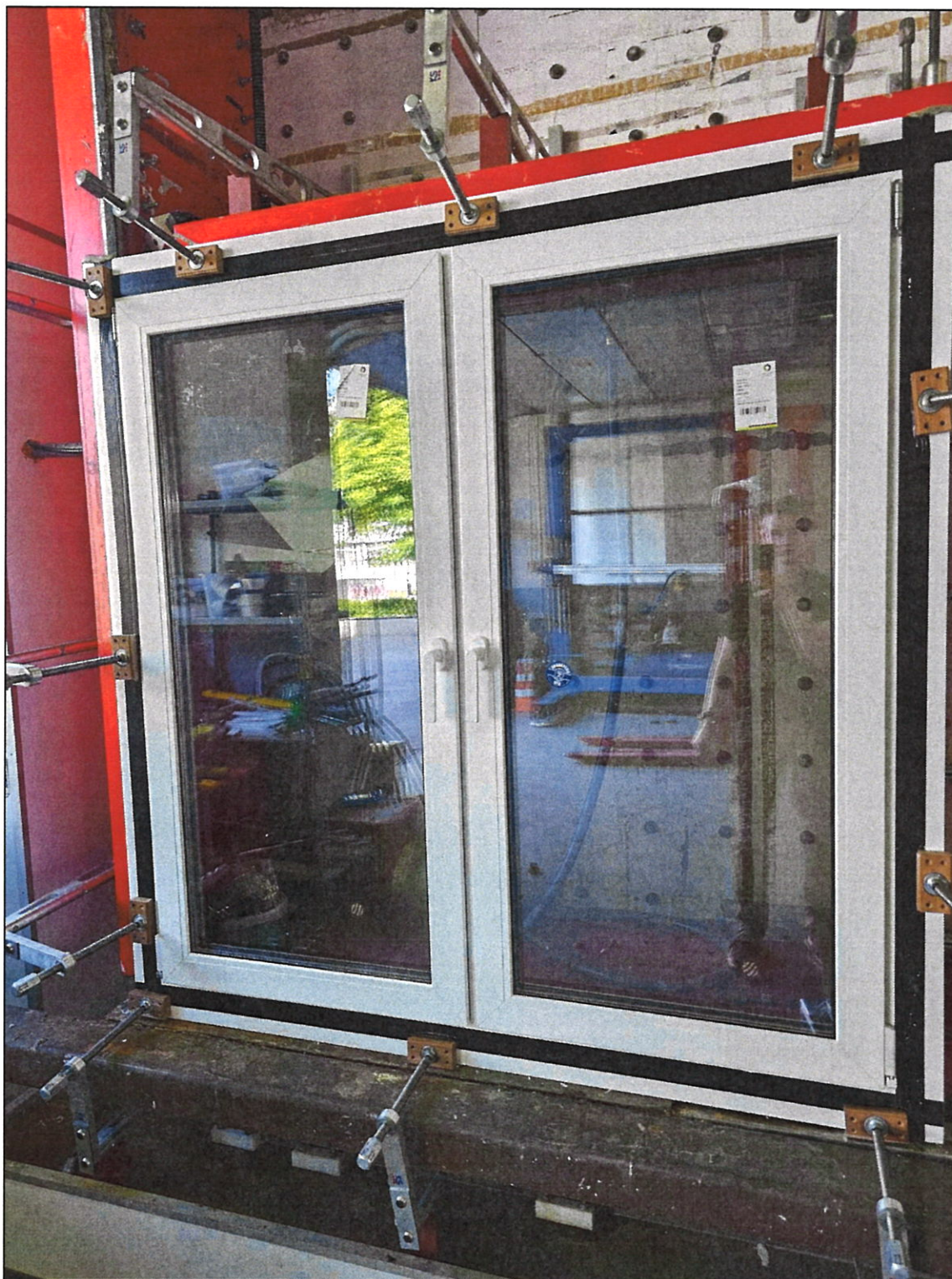
Рисунок 1– Образец 994-24-2-2, установленный на испытательный стенд (на этапе проведения испытаний на воздухопроницаемость)
