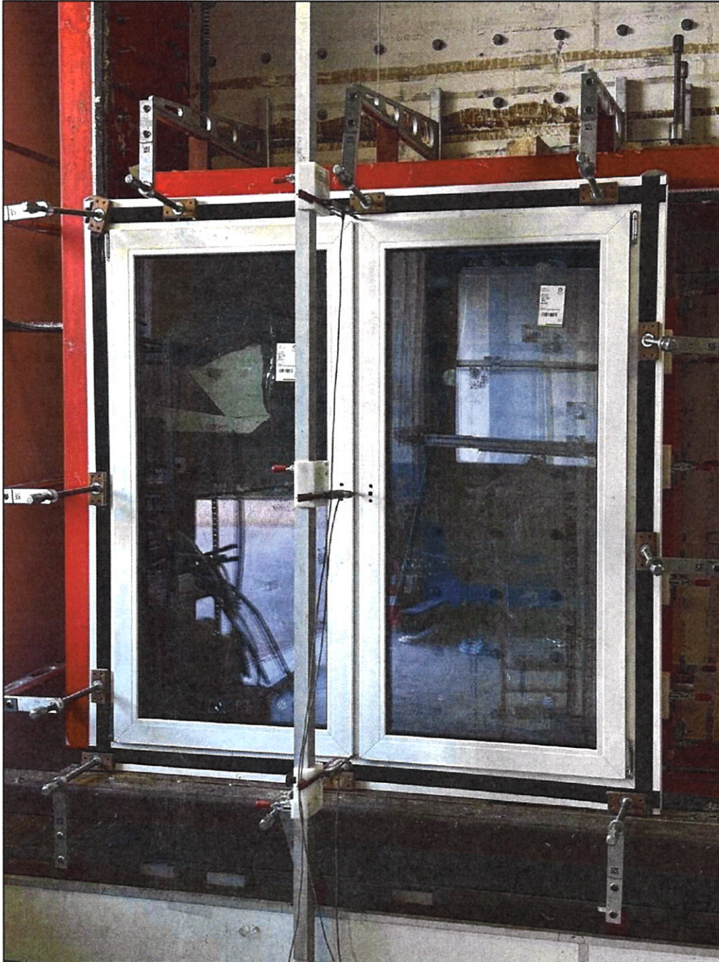
Рисунок 8– Внешний вид образца 994-24-2-1 в процессе испытаний на сопротивление ветровой нагрузке
