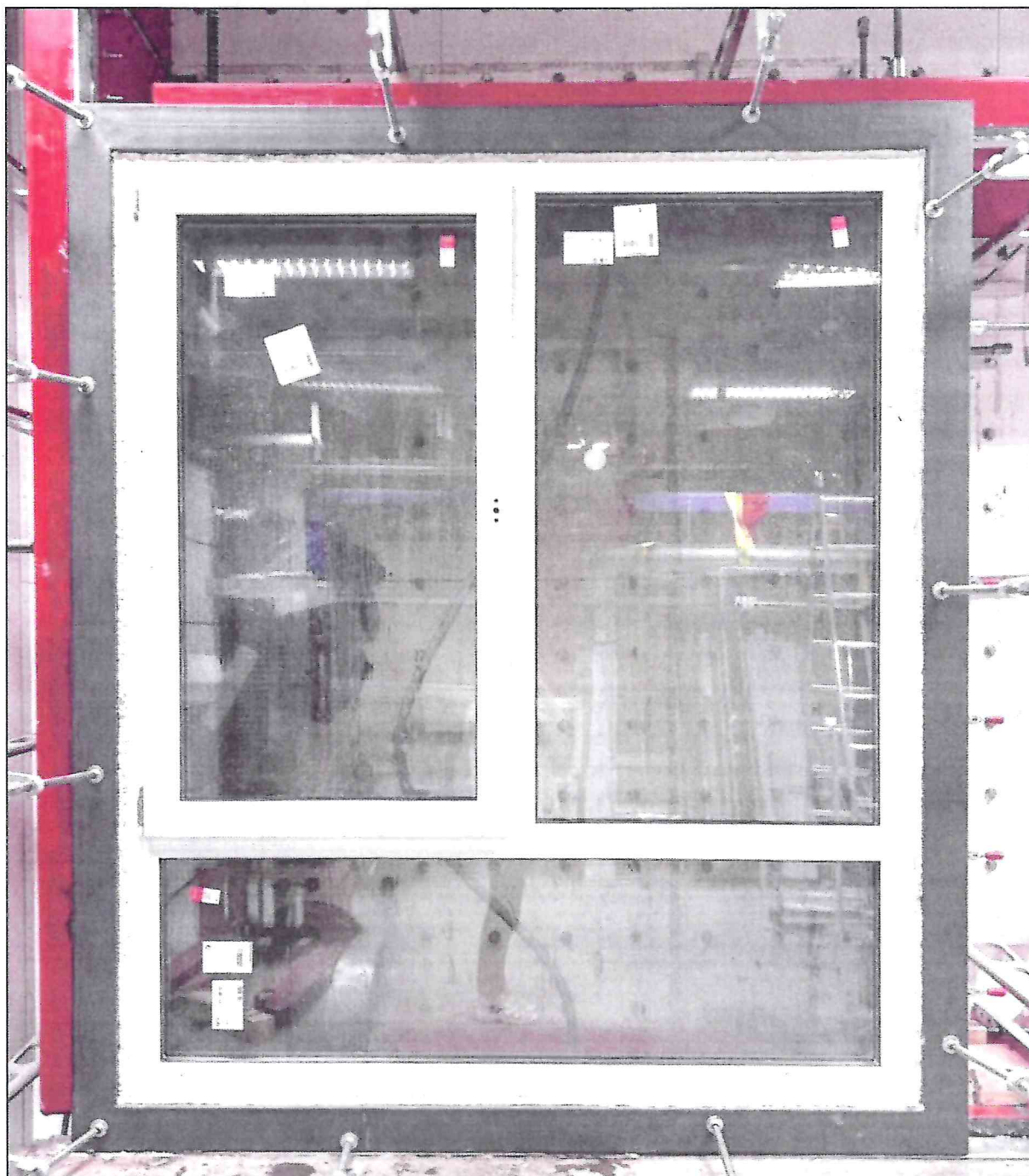
Рисунок 6– Внешний вид образца 994-24-1 в процессе испытаний на водонепроницаемость
